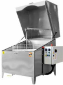
Chauffant pour les détergents aqueux. Pour éliminer les salissures d'huile et de graisse en un temps record. Utilisation universelle pour le nettoyage entièrement automatique de petites pièces issues de la production, de la fabrication, de la maintenance, comme par exemple les boulons, les douilles, les roulements à billes.
